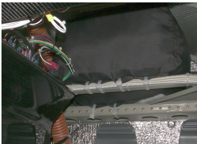
Obrázek 7-12 Plastové stahovací pásy (bílé) k uchycení poudra s padákem ke konstrukci letounu
