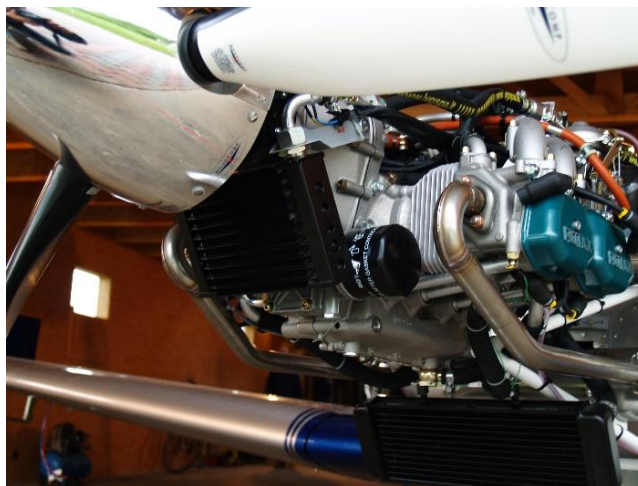
Obrázek 10-15 Uchycení chladiče k motoru
