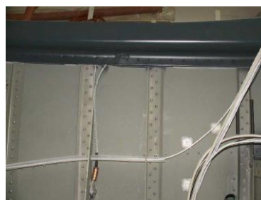
Obrázek 7-8 Levý zadní zvěs s připojeným ocelovým lanem
